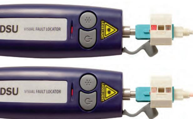
El **localizador de fallas visuales (VFL)** de Leviton utiliza un láser rojo brillante para localizar las fallas en la fibra óptica, como flexiones, rupturas y conectores defectuosos. Con cada VFL se incluye una interfaz de férula de 2.5 mm para conectores tipo ST y SC, un adaptador de 1.25 mm para conectores LC y estuche suave. Se usa con conectores LC, SC y ST FastCAM.
